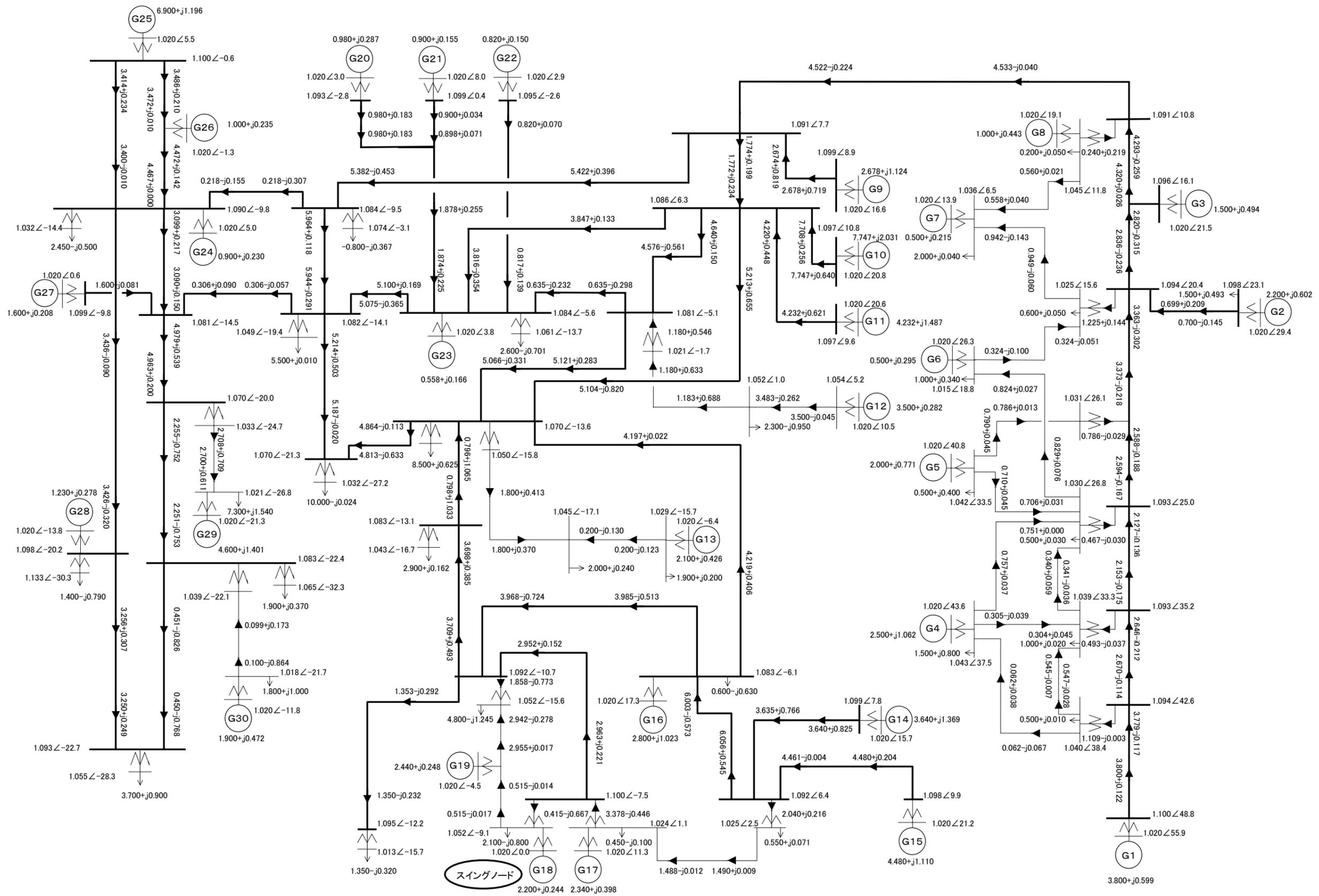
4.17図 (a) 電気学会EAST30機系統モデル 潮流図(昼間断面)
