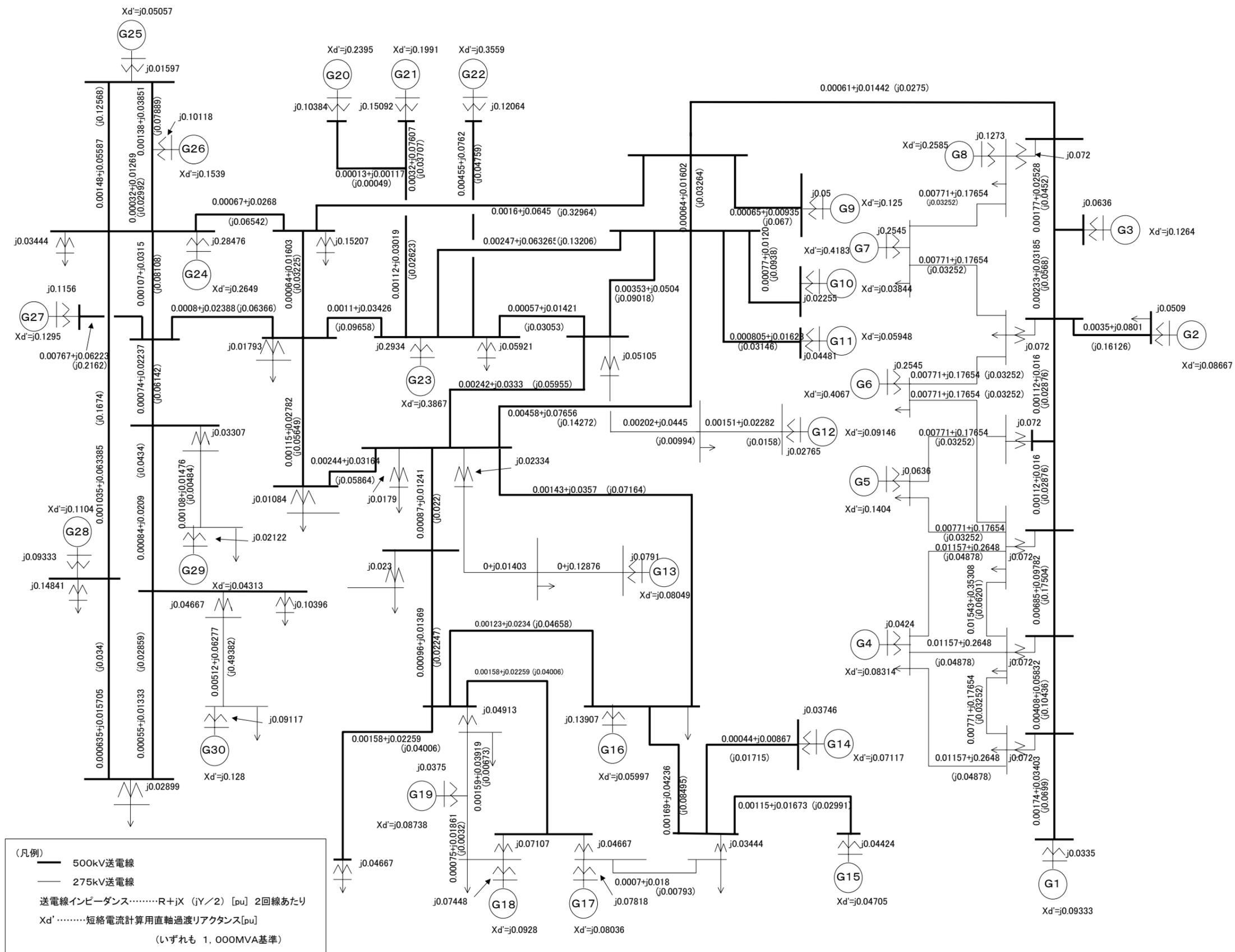
4.16図 電気学会EAST30機系統モデル インピーダンスマップ
